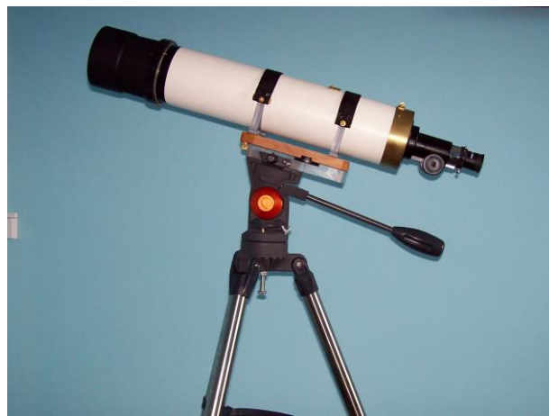
Самодельный 100-мм рефрактор с объективом от трубы «Юкон 6-100×100» на азимутальной монтировке от телескопов серии «AstroMaster».
