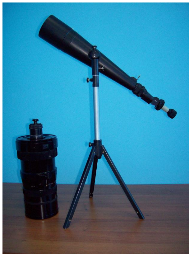
Зрительная труба ЗРТ-457М на штатном настольном штативе, с дополнительной оптикой, позволяющей получить увеличение 120^{\times} , и астрономическая труба на базе фотообъектива МТО-1000 с окуляром от зрительной трубы «Донец 20 \times 46 », дающим увеличение 110^{\times} .
